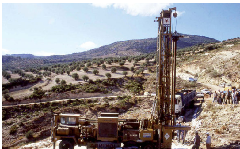
Figura 4.3. Máquina de perforación a rotopercusión.
