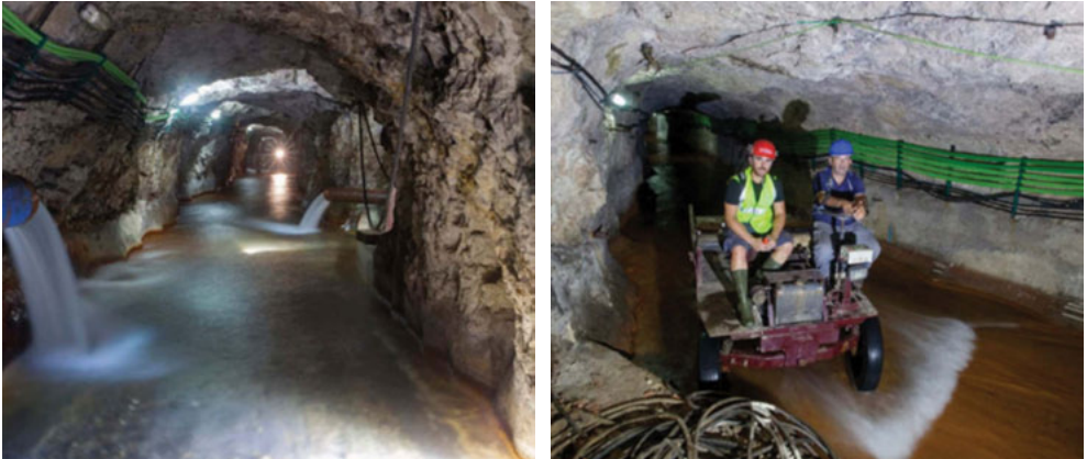
Figura 2.8. Galería Los Suizos con varios sondeos en funcionamiento vertiendo el agua a la galería principal. A la derecha medio de movimiento a través de la galería.
