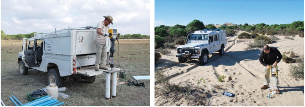
Figura 3.2. Construcción sondeos con una perforadora para realizar sondeos cortos y control de piezómetro.
